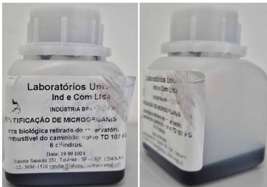
Figura 3: Amostra de Borra coletada do reservatório do caminhão marca Volvo Modelo TD 102FS de 6 cilindros, laboratório Universal identificada como Graxa Preta.
